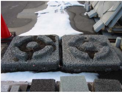
図15 寒冷地冬期屋外暴露状況 (平成19年3月)
