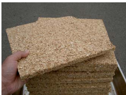
図4 作成した保水性ボード
