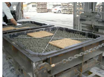
図7 保水性ボード組み込み状況
